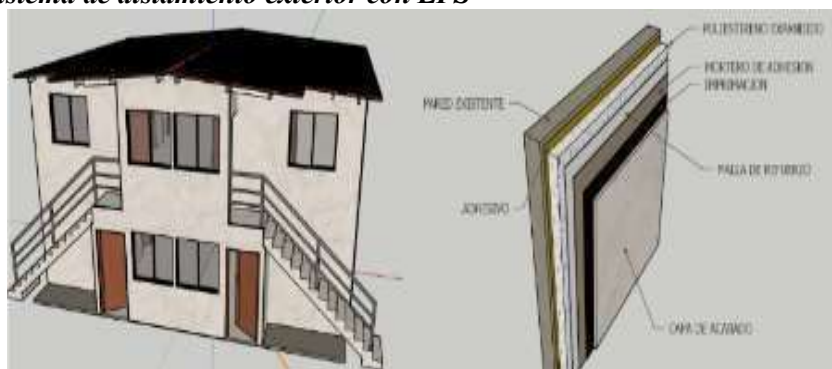
Figura 3: Sistema de aislamiento exterior con EPS
