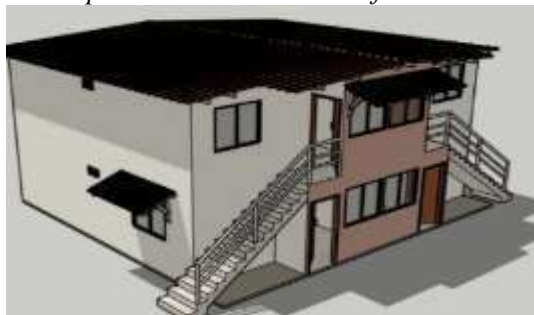
Figura 4: Colocación de aleros para asombramiento en fachadas.
