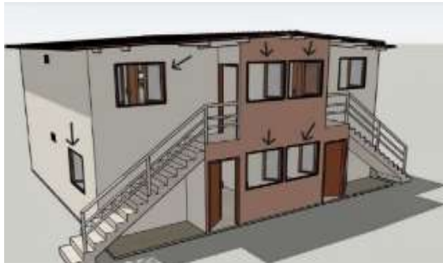
Figura 6: Ventilación Natural mediante uso de ventanas abatibles
